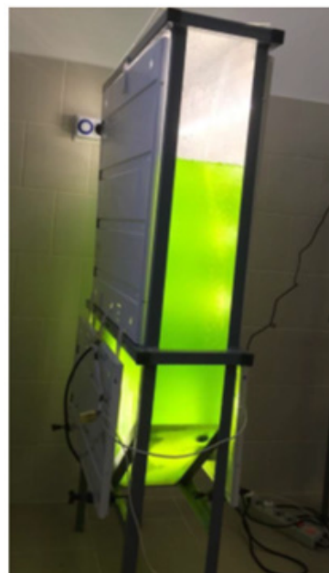
Рисунок 6 – Фотобиореактор для культивирования микроводорослей, где а) схема фотобиореактора, б) культивирование микроводорослей в лабораторных условиях
