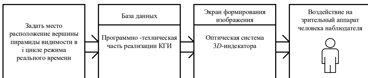
Рисунок 1 – Распределение трехмерных изображений в авиационном тренажере
