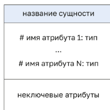
Рисунок 3 – Логическая модель в общем виде
