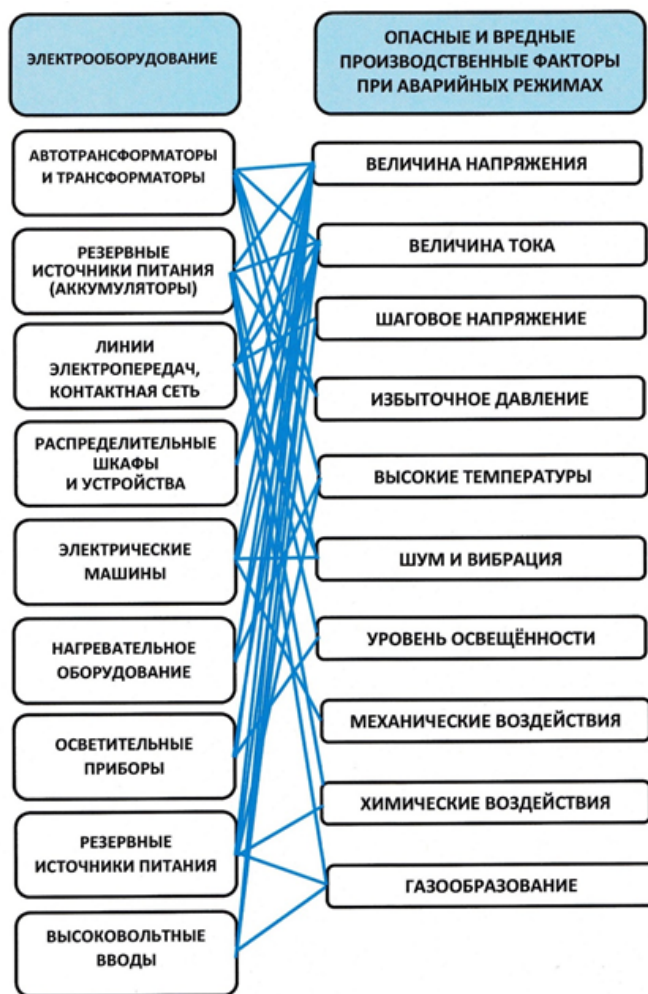
Рисунок 3 – Проявление опасных и вредных производственных факторов при авариях и неисправностях в энергетических хозяйствах предприятий
