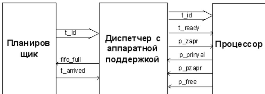
Рисунок 4 – Интерфейс взаимодействия диспетчера с планировщиком и процессором
