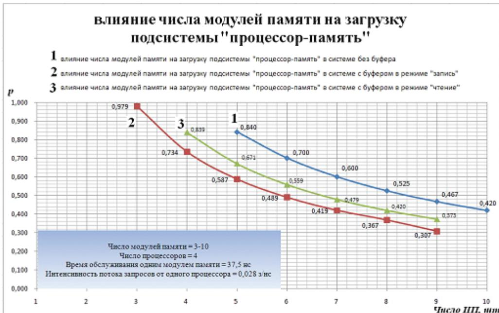
Рисунок 5 – Влияние числа модулей памяти на её загрузку в многопроцессорной системе UMA без буферного устройства и при его наличии при обращении к памяти
