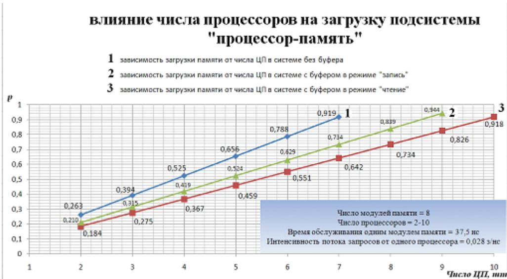
Рисунок 4 – Влияние числа ЦП на загрузку памяти в многопроцессорной системе UMA без буферного устройства и при его наличии при обращении к памяти
