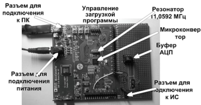
Рисунок 1 – Отладочная плата с микроконвертором ADuC841
