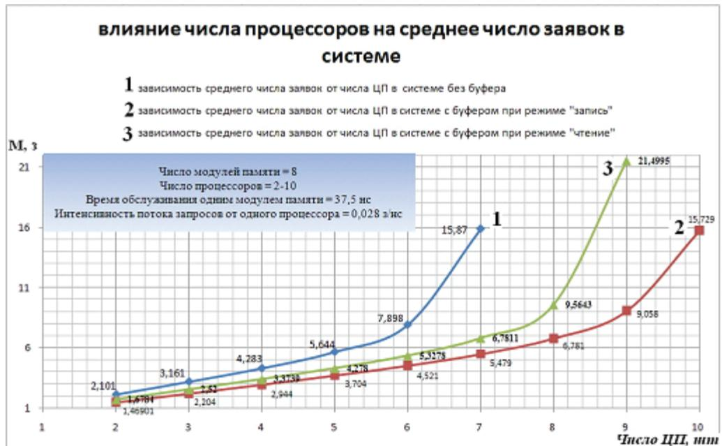
Рисунок 6 – Влияние числа процессоров на среднее число задач в многопроцессорной системе UMA без буферного устройства и при его наличии при обращении к памяти
