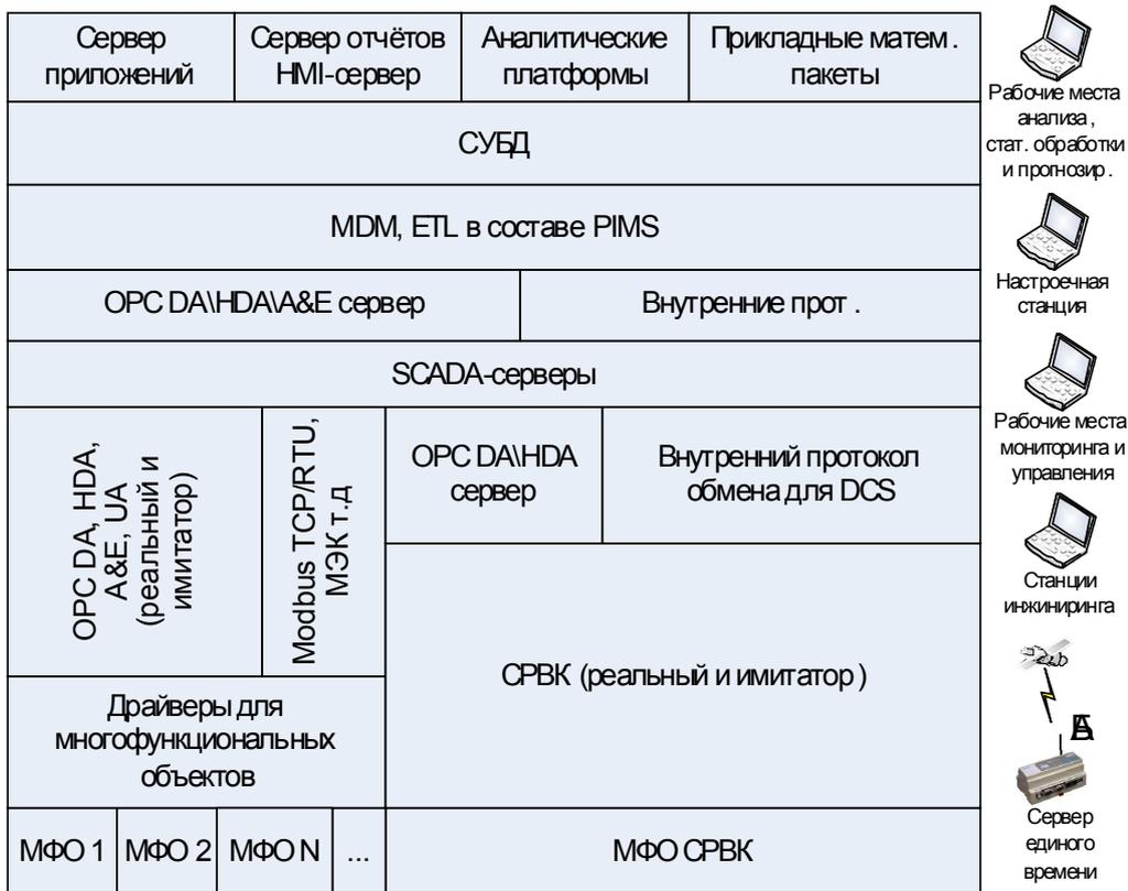
Рис. 2. Структура программной платформы ИКСАЛ
