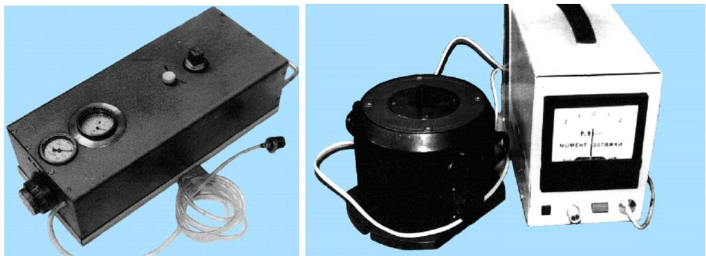
Рис. 3. Устройства для настройки гайковертов по крутящему моменту (патенты РФ 2199099 и 2112639)
