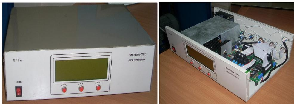
Рис. 2. Модуль управления
