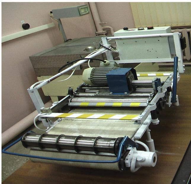
*Рис. 4. Общий вид четырехвалковой тестораскатывающей машины*
