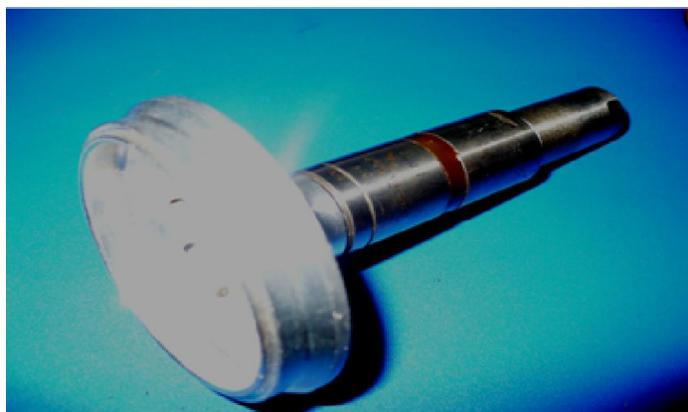
Рис. 2. Высокоскоростной ротор для устройства измельчения
