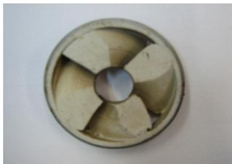
Рис. 2. Аксиально-лопаточный завихритель
