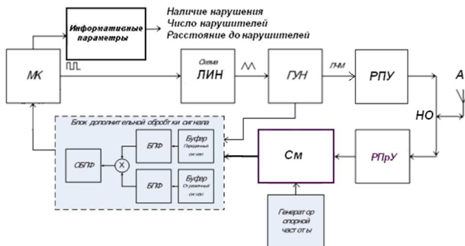
Рисунок 2 – Структурная схема РЛТСО с вейвлет-преобразованием
