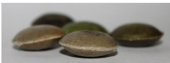
Рисунок 2 – Абразивные рабочие тела в форме двояковыпуклой линзы
