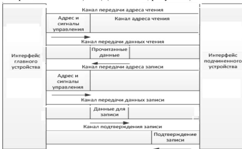
Рисунок 2 – Пять параллельных каналов интерфейса AXI-Lite
