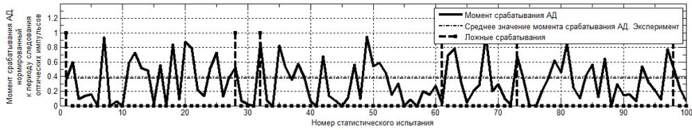
*Рисунок 3 – Изменения момента срабатывания амплитудного дискриминатора*
