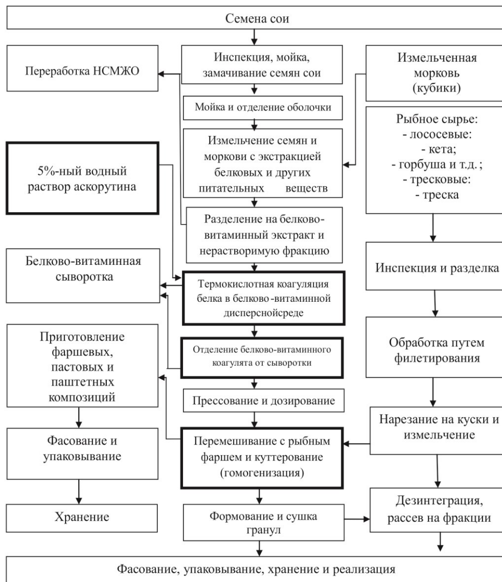
Рисунок 2 – Технологическая схема производства рыборастворительных продуктов фаршевой, пастовой и сухой формы заданного состава и свойств
