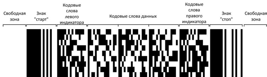
Рисунок 2 – Состав двухмерного штрих-кода в формате *PDF417*
