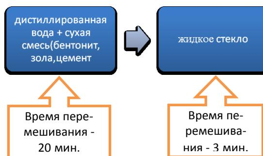
*Рисунок 3 – Последовательность смешивания сухой смеси компонентов при получении композитного раствора*
