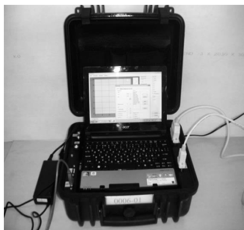
Рисунок 1 – Прибор контроля и диагностики систем пожарной автоматики «КОД – СПА»
