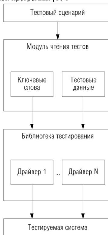
Рисунок 2 – Схема автоматизированного тестирования с помощью ключевых слов
