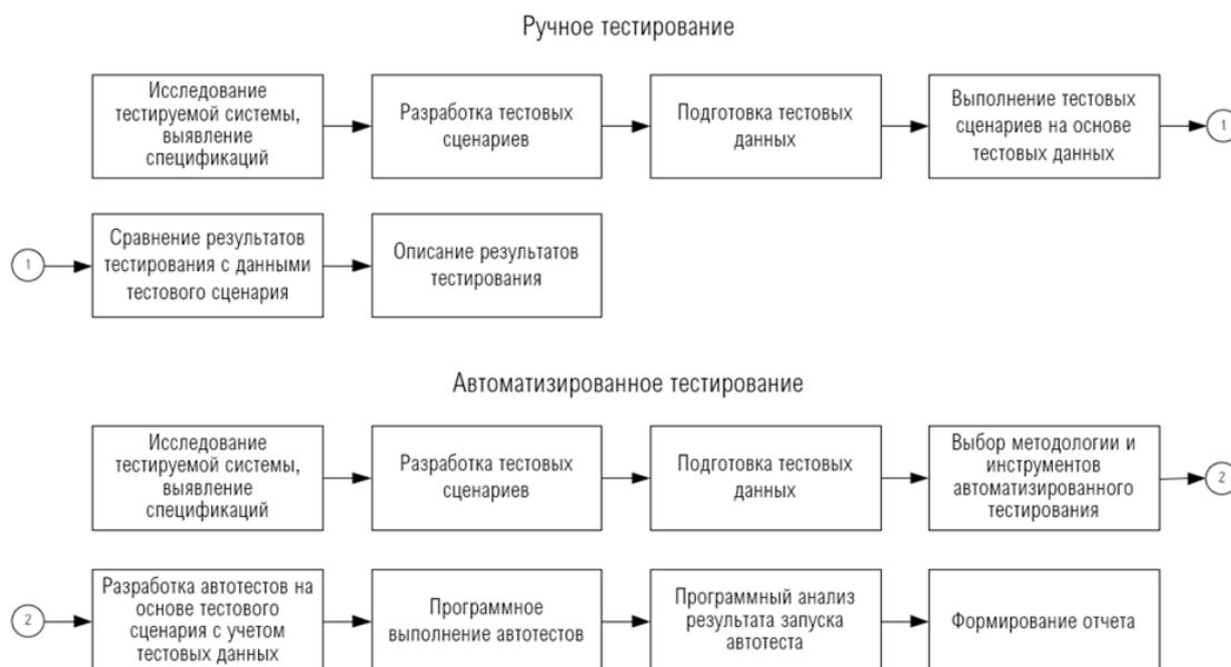
Рисунок 1 – Схема ручного и автоматизированного тестирования
