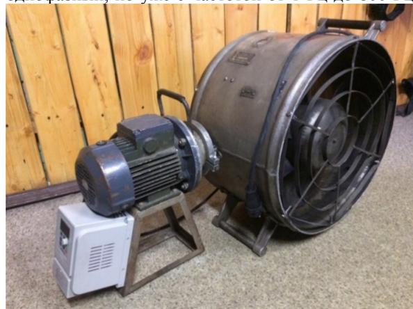
Рисунок 1 – Частотный преобразователь, смонтированный к вентилятору ДПЭ-7
