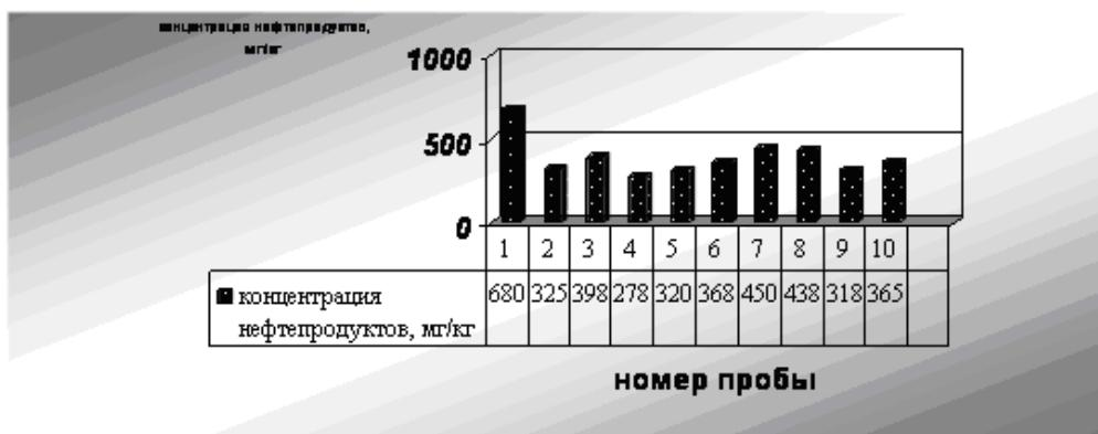
Рисунок 3 – Зависимость концентрации нефтепродуктов в почве полосы отвода железнодорожного транспорта от вида реагентов и их сочетаний
