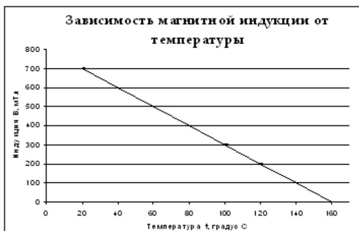
Рисунок 2 – Зависимость магнитопроницаемости датчика от температуры
