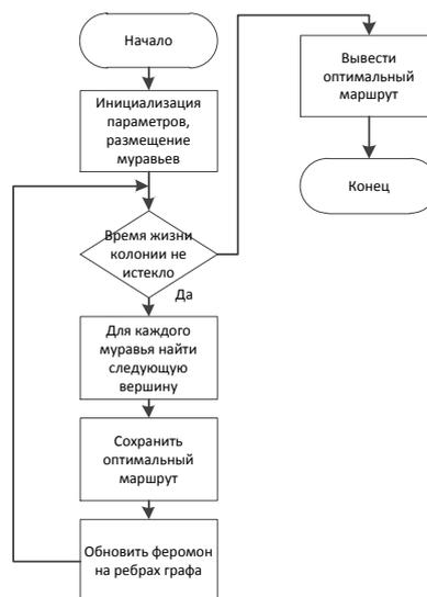
Рисунок 3 – Блок-схема муравьиного алгоритма
