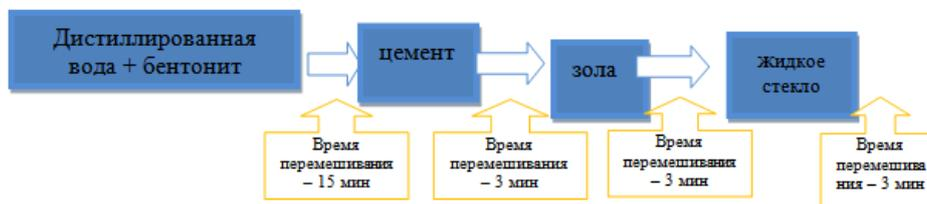
*Рисунок 1 – Последовательность смешивания компонентов при получении композитного раствора*
