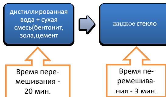
Рисунок 3 – Последовательность смешивания сухой смеси компонентов при получении композитного раствора
