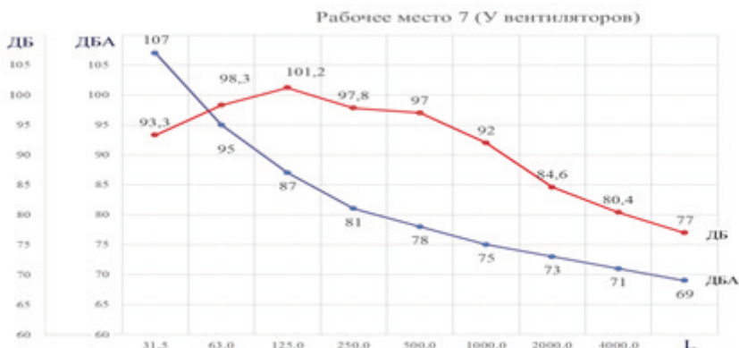
Рисунок 6 – Шум и вибрации ополаскивателя бутылок в зависимости от расстояния от источника
