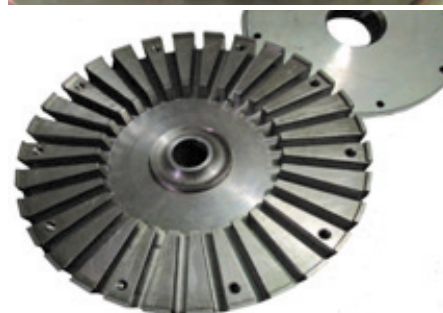
Рисунок 1 – Примеры конструктивных исполнений распылительных центробежных дисков
