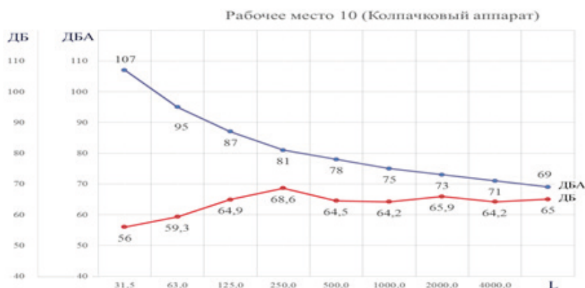
Рисунок 7 – Шум и вибрации ополаскивателя бутылок в зависимости от расстояния от источника
