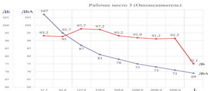
Рисунок 4 – Шум и вибрации ополаскивателя бутылок в зависимости от расстояния от источника
