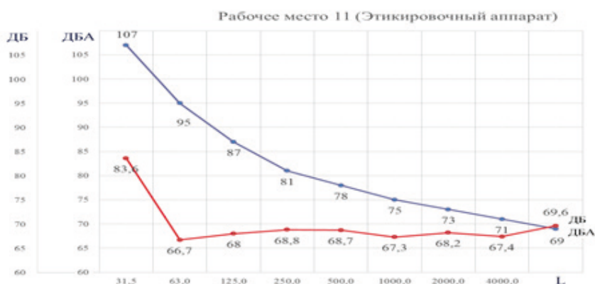
Рисунок 8 – Шум и вибрации ополаскивателя бутылок в зависимости от расстояния от источника
