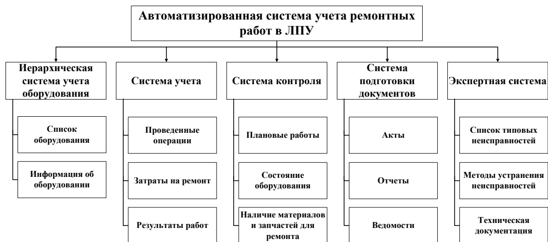
Рисунок 1 – Обобщенная структура автоматизированной системы ТО и Р в лечебно-профилактическом учреждении
