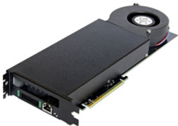
Рисунок 2 – Модуль MC 127.05 со СБИС 1879VM8Я
