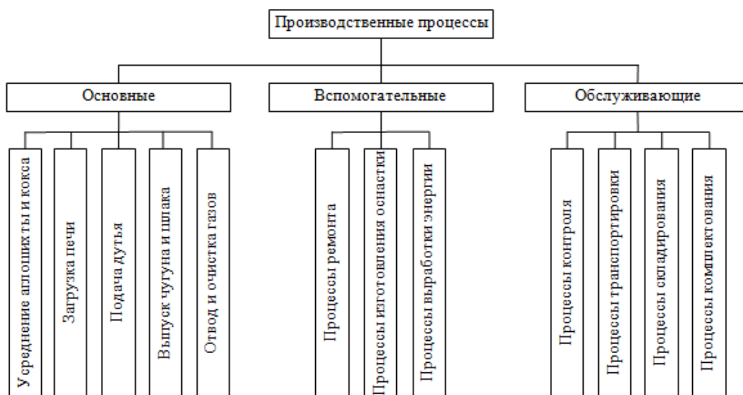
Рисунок 2 – Структура производственных процессов
