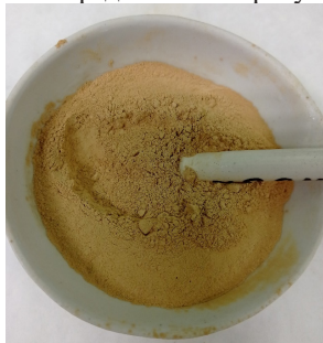
Рисунок 2 – Внешний вид обезвоженного шлама с участка водоподготовки Пензенской ТЭЦ-2
