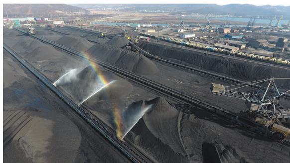
Рисунок 1 – Гидроорошение в крупнейшем в Российском порту по перевалке угля АО «Восточный Порт»
