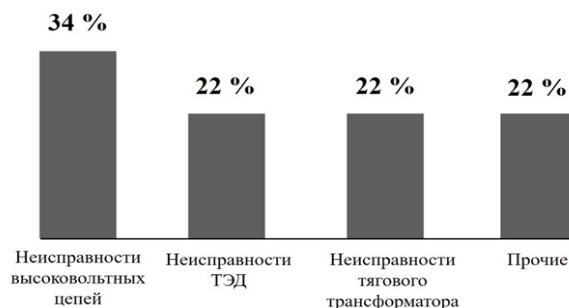
Рисунок 2 – Технические неисправности электровозов – причины пожаров
