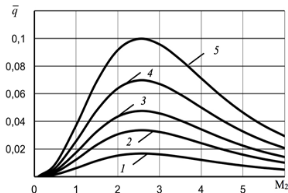
Рисунок 4 – Влияние факторов M_2 , G на температурную стратификацию в дисперсном потоке: 1 – G = 0 (однородный поток); 2 – 5 \cdot 10^9 ; 3 – 5 \cdot 10^8 ; 4 – 5 \cdot 10^7 ; 5 – 5 \cdot 10^6
