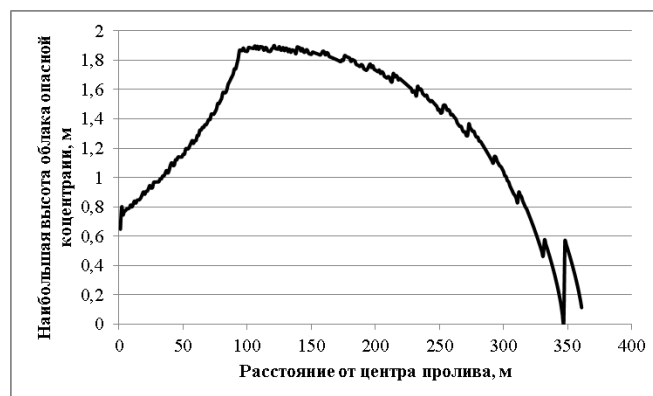
Рисунок 3 – Зависимость наибольшей высоты облака опасной концентрации газа от расстояния до центра пролива
