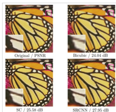
Рисунок 2 – Сравнение работы метода SRCNN с оригинальным изображением, бикубическим методом увеличения качества ( Bicubic ) и разреженным кодированием ( sparse-coding, SC )
