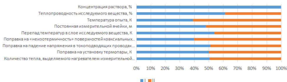
Рисунок 2 – Результаты расчетов систематической и случайной погрешности измерения коэффициента теплопроводности
