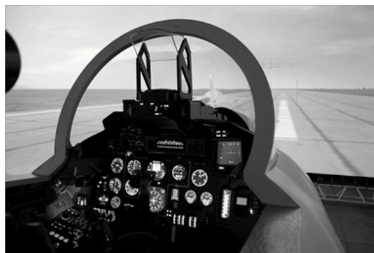
Рисунок 1 – Вид на 3D-модель пространства, окружающего кабину авиационного тренажёра
