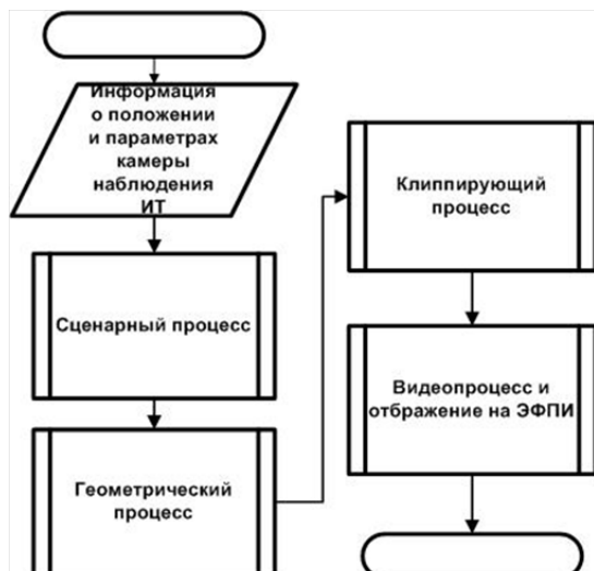
Рисунок 4 – Схема процессов обработки информации в программно-технической системе «Имитатор тепловизора», позволяющего лётчику при полётах на авиационном тренажёре наблюдать узнаваемую ИК-модель местности
