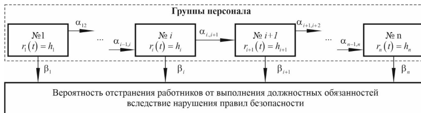
Рисунок 1 – Схема изменения номера группы персонала по уровню риска по количеству нарушений требований безопасности
