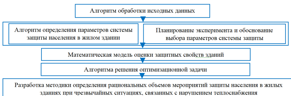
Рисунок 1 – Схема научно-методического аппарата методики определения рациональных объемов мероприятий защиты населения в зданиях при чрезвычайных ситуациях, связанных с нарушением теплоснабжения
