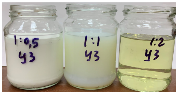
Рисунок 7 – Исследуемые образцы эмульсии с различной концентрацией эмульгатора после перемешивания при помощи магнитной мешалки и УЗ-обработки
