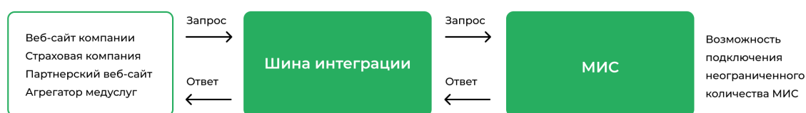
Рисунок 1 – Принцип работы интеграционной шины
