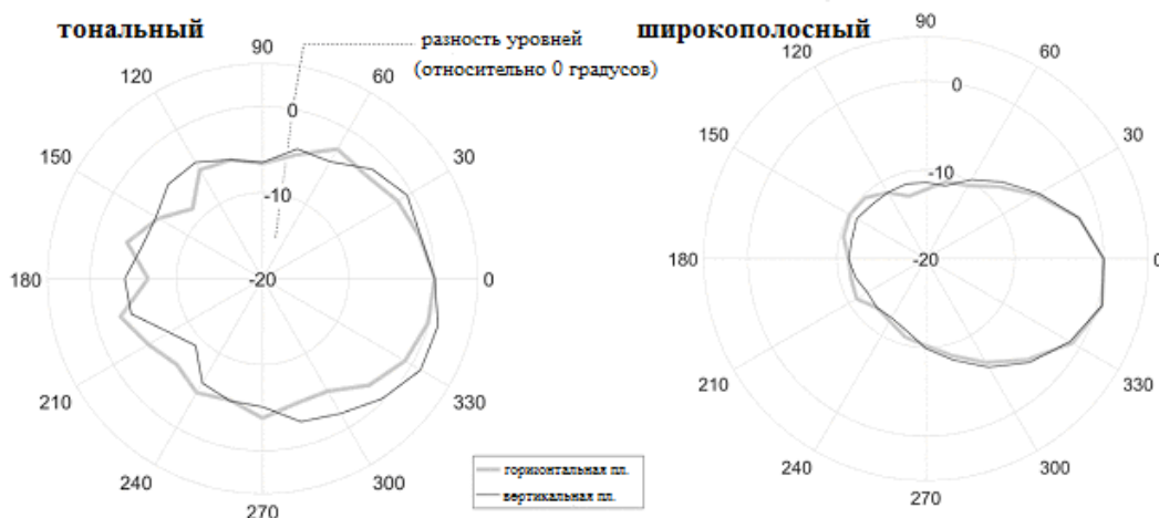
Рисунок 7 – Направленность звука, создаваемого серийными сигнализациями, в горизонтальной и вертикальной плоскостях
