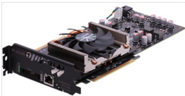
Рисунок 3 – Модуль MC 127.05 – гетерогенная мультипроцессорная система на чипе K1879BM8Y
