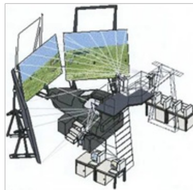
Рисунок 5 – Схема пилотажного авиационного тренажёра с тремя 2D-индикаторами с экранами высокой чёткости, что позволяет во время полёта лётчику видеть в углах обзора 180^\circ по горизонтали неплоское изображение модели района полётов во время пилотирования модели летательного аппарата по визуально наблюдаемой линии горизонта [27]
