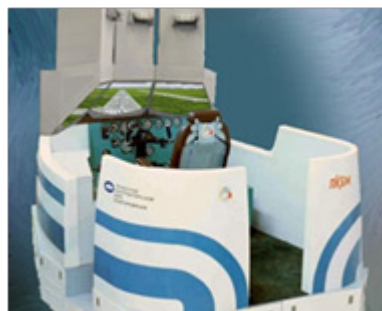
Рисунок 4 – Пилотажный авиационный тренажёр с тремя безочковыми 3D-индикаторами типа ОКУ [27]
