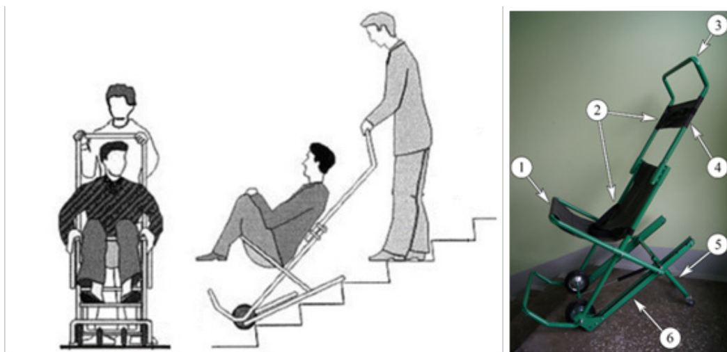
Рисунок 2 – Эвакуационный стул (кресло) и его основные узлы 1 – сиденье, 2 – ремни безопасности, 3 – верхняя рама, 4 – подголовник, 5 – задняя опорная стойка, 6 – колеса
