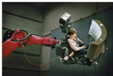
Рисунок 3 – Пилотажный тренажёр с имитатором подвижности и трёхканальным ИВО с тремя 3D-индикаторами с вогнутыми поверхностями совмещёнными в единый блок [26]
