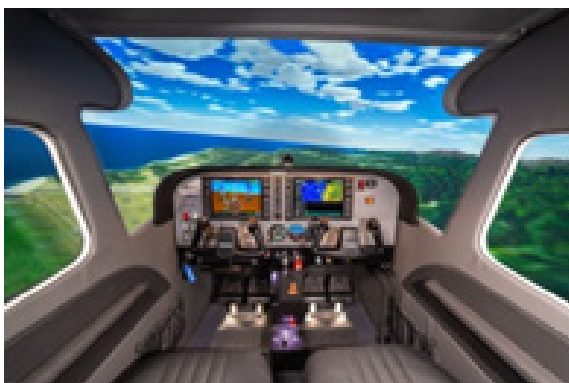
Рисунок 1 – Вид из кабины АТ на 3D-модель внешнего пространства синтезированную трёхканальным ИВО, каждый канал включает в себя 3D-индикатор типа WIDE [24]
