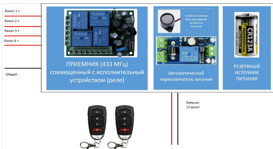
Рисунок 10 – Схема возможного исполнения 4 канального АУИП с применением готовых комплектующих
