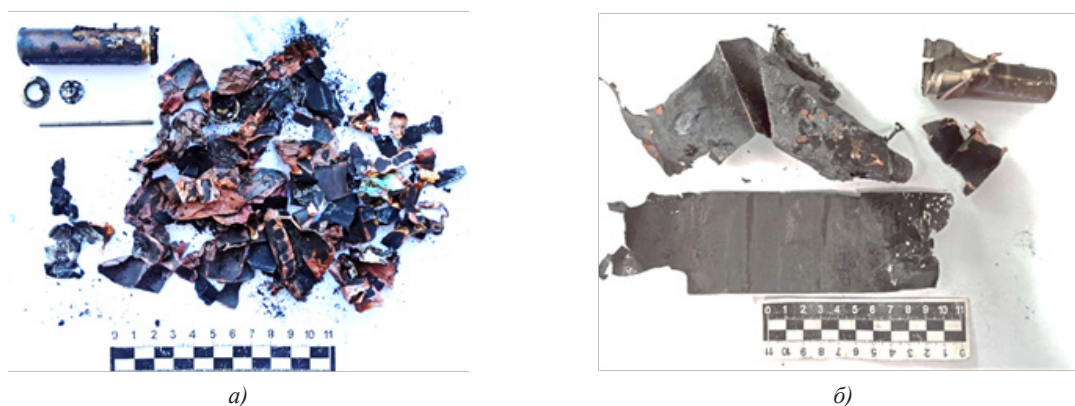
Рисунок 1 – Внешний вид содержимого литий-ионной аккумуляторной батареи после теплового разгона, а – 50 % заряд батареи; б – 100 % заряд батареи
