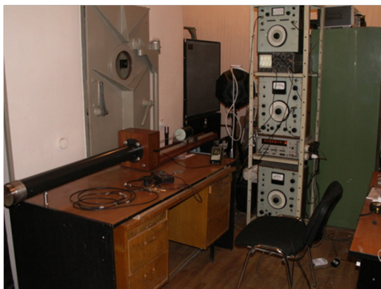
Рисунок 2 – Экспериментальный стенд – труба Кундта (составлено авторами)
