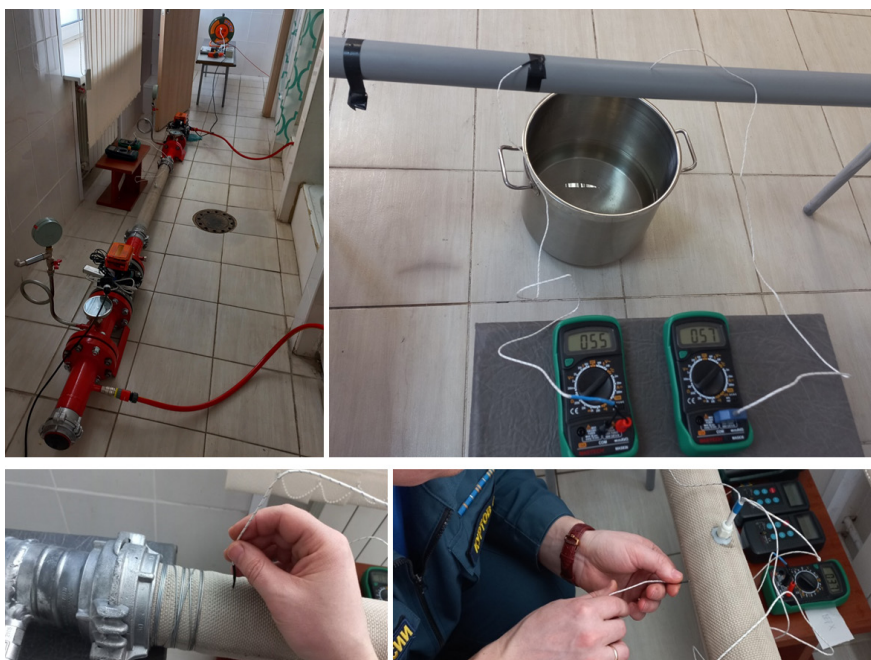
Рисунок 1 – Устройство экспериментальной установки для измерения радиально-азимутального распределения температуры воды в рукавах пожарных напорных диаметром 51 мм и 77 мм
