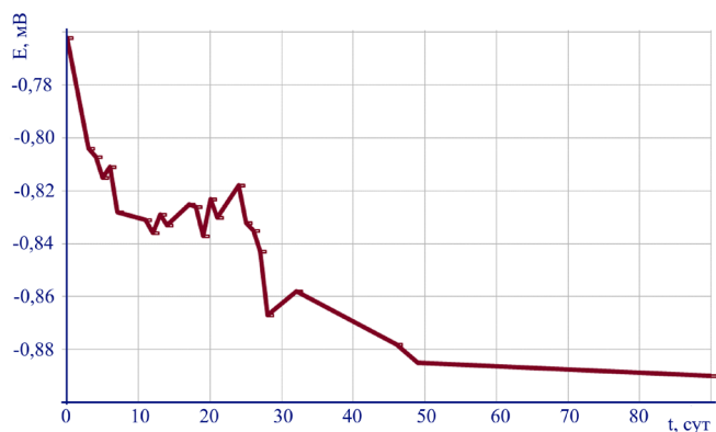
Рисунок 7 – Разность потенциалов в топливном элементе с катодом Sn@Pd90Fe10/Cu и анодом Nifoam/Cu при длительной выдержке
