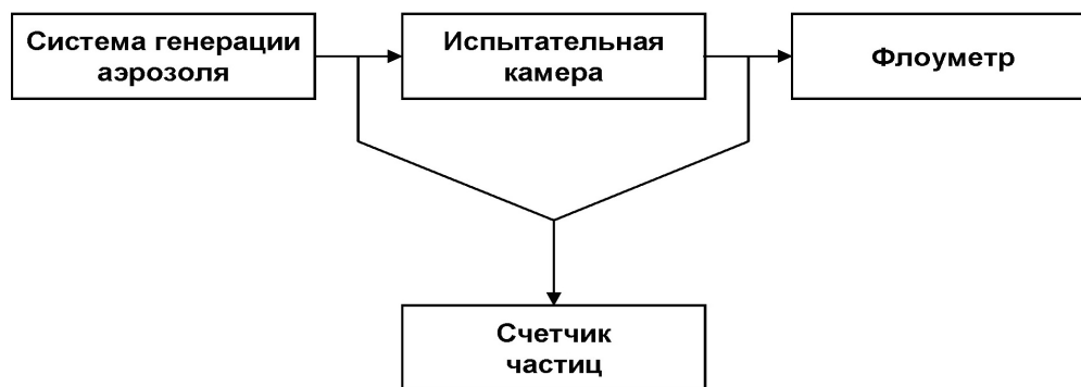
Рисунок 2 – Принципиальная схема установки для определения эффективности фильтрации наночастиц
