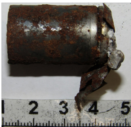
Рисунок 7 – Повреждения обнаруженные на фрагменте литий – ионного аккумулятора после пожара
