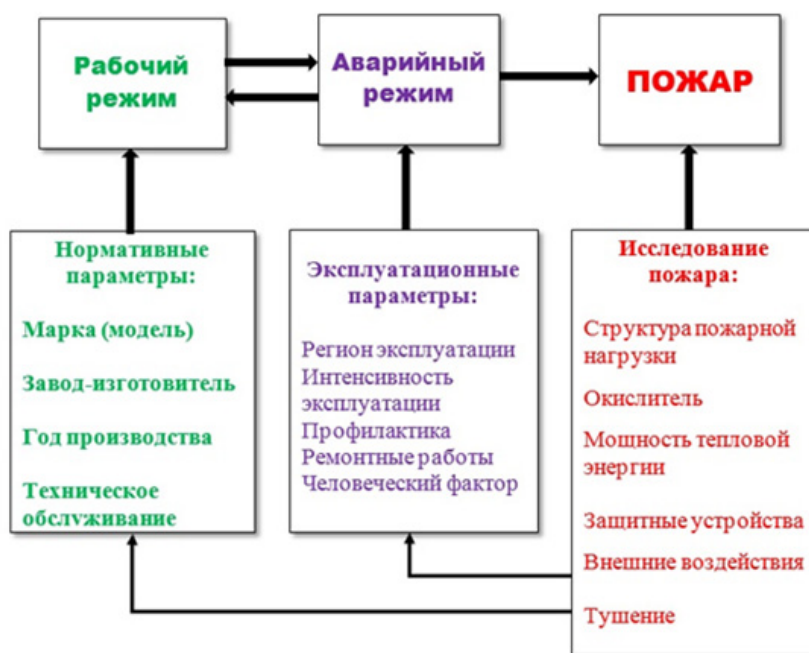
Рисунок 2 – Параметры, влияющие на жизненный цикл и состояние автотранспортного средства на каждом этапе эксплуатации
