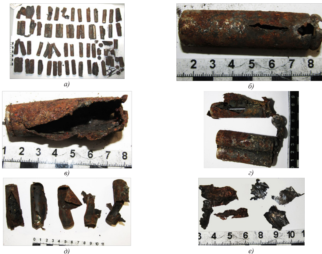
Рисунок 2 – Повреждения, обнаруженные на фрагментах литий-ионных аккумуляторных батарей
