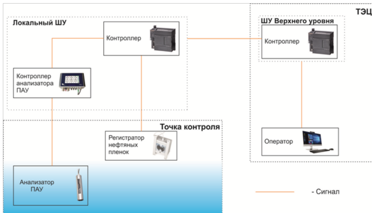
Рисунок 2 – Схема расположения оборудования на точке контроля
