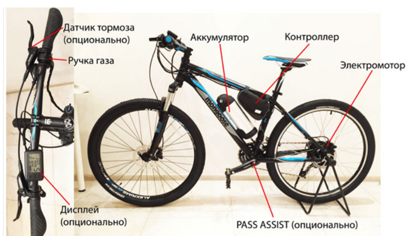
Рисунок 1 – Устройство электрического велосипеда
