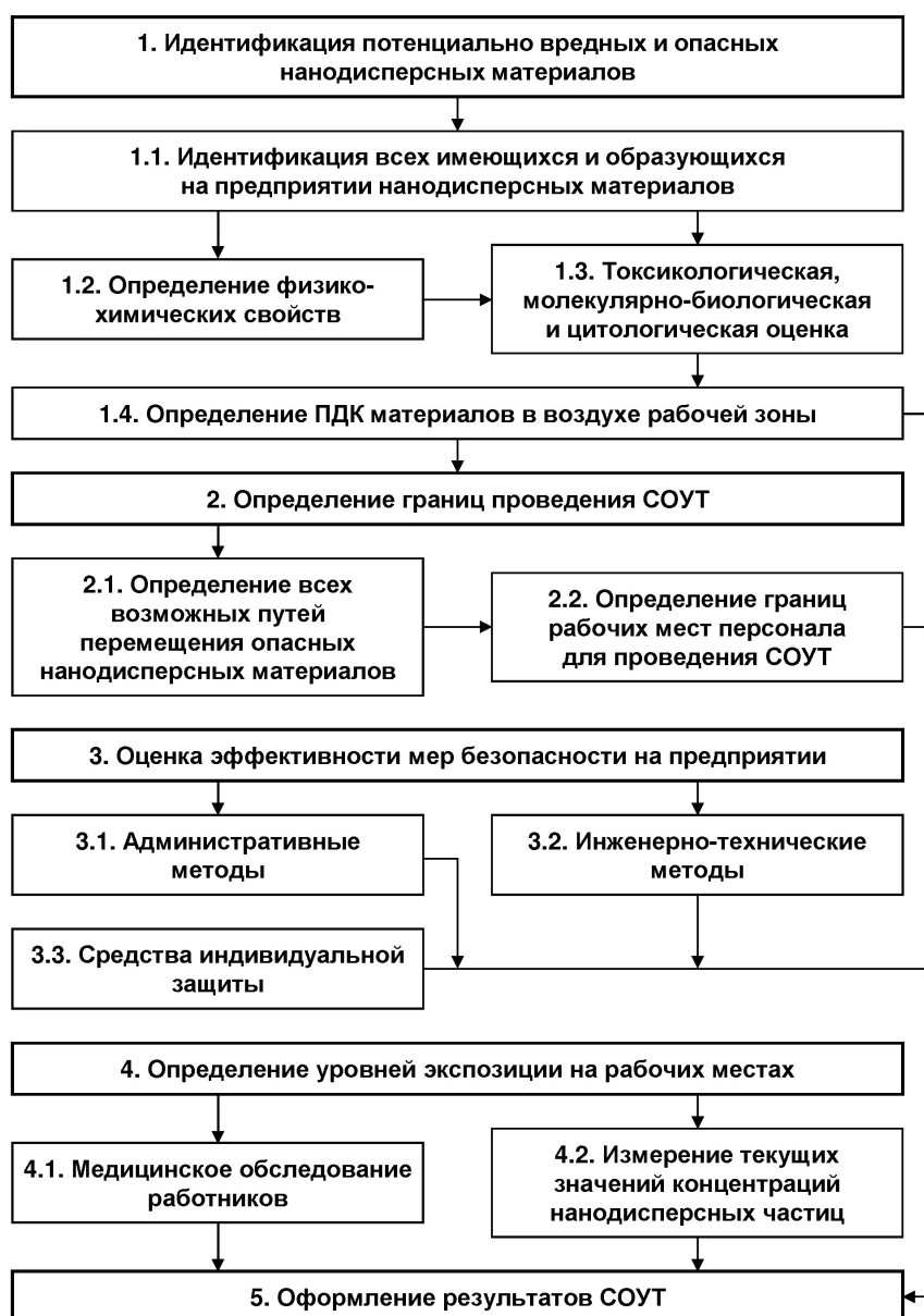
Рисунок 1 – Схема проведения СОУТ на предприятиях с нанодисперсными материалами
