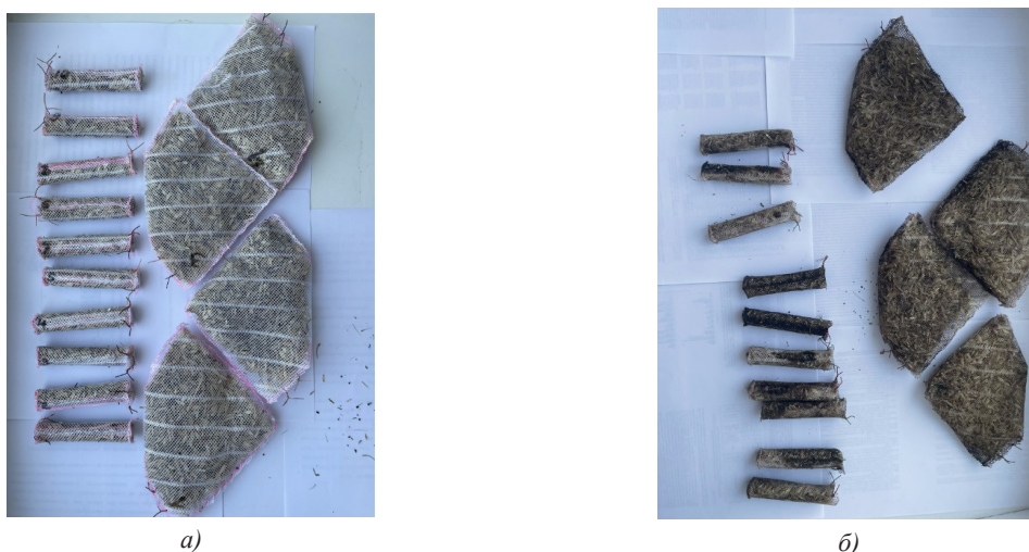
Рисунок 7 – Маты и боны из СМ: а) до сбора нефти; б) после сбора нефти с поверхности воды
