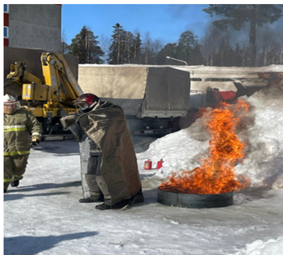
Рисунок 9 – Фотография процесса тестирования системы защиты тела человека при самоспасании из зоны пожара
