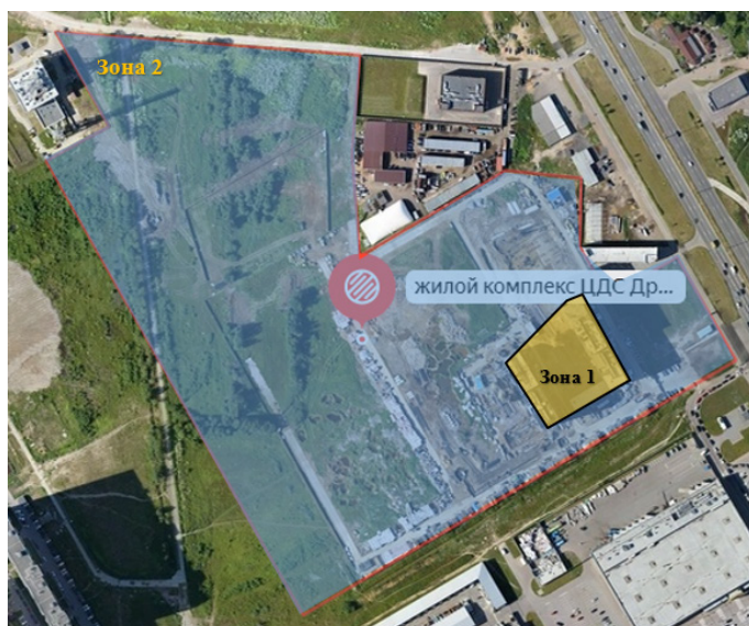
Рисунок 2 – Деление строительной площадки на зоны
