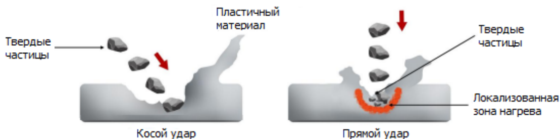
Рисунок 6 – Механизм образования эрозии на пластичной поверхности
