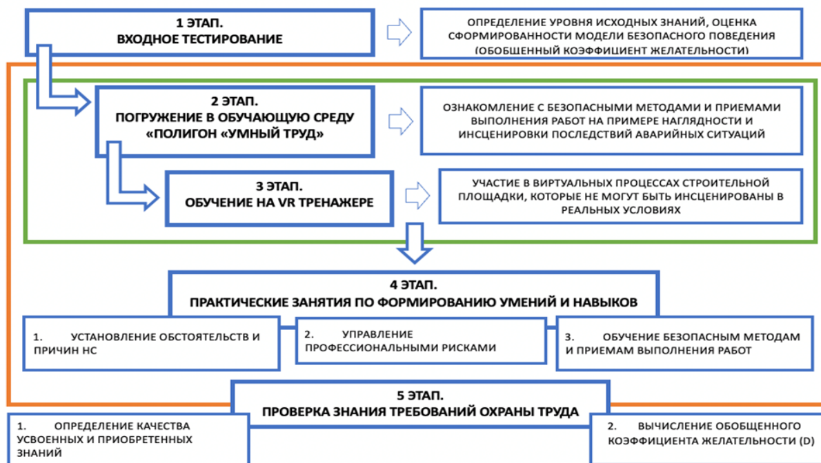
Рисунок 1 – Алгоритм процесса обучения с использованием современных образовательных технологий для обеспечения безопасности труда в строительной отрасли
