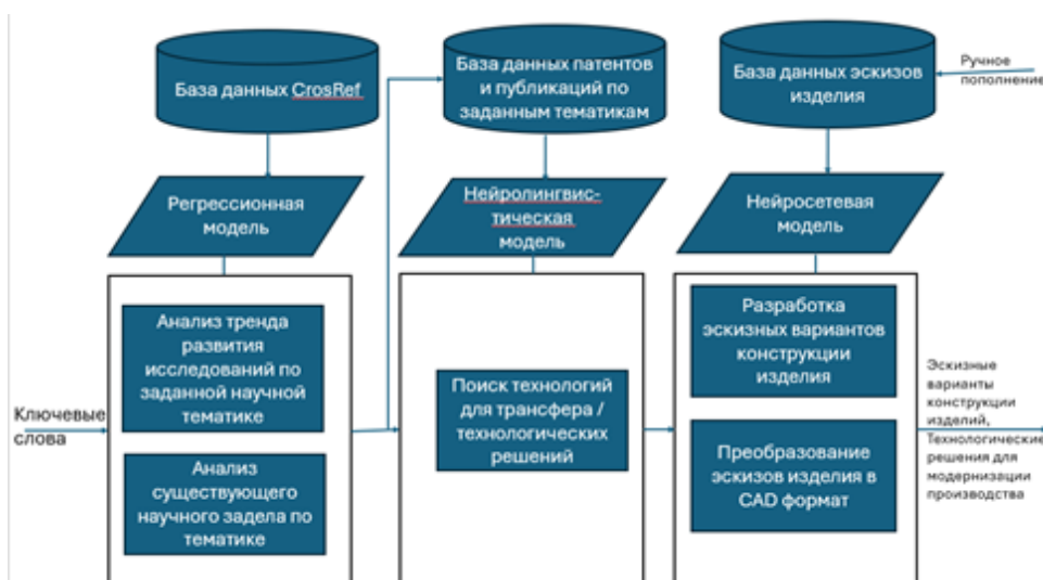
Рисунок 9 – Функциональная модель отделов R&D производства
