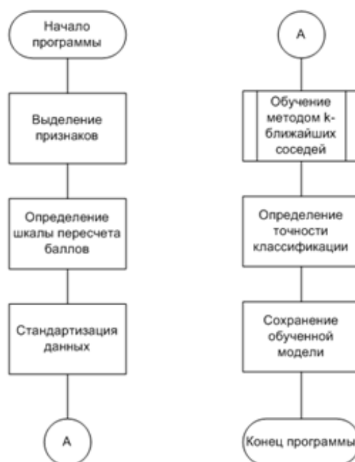
Рисунок 2 – Блок-схема алгоритма обучения модели нейронной сети
