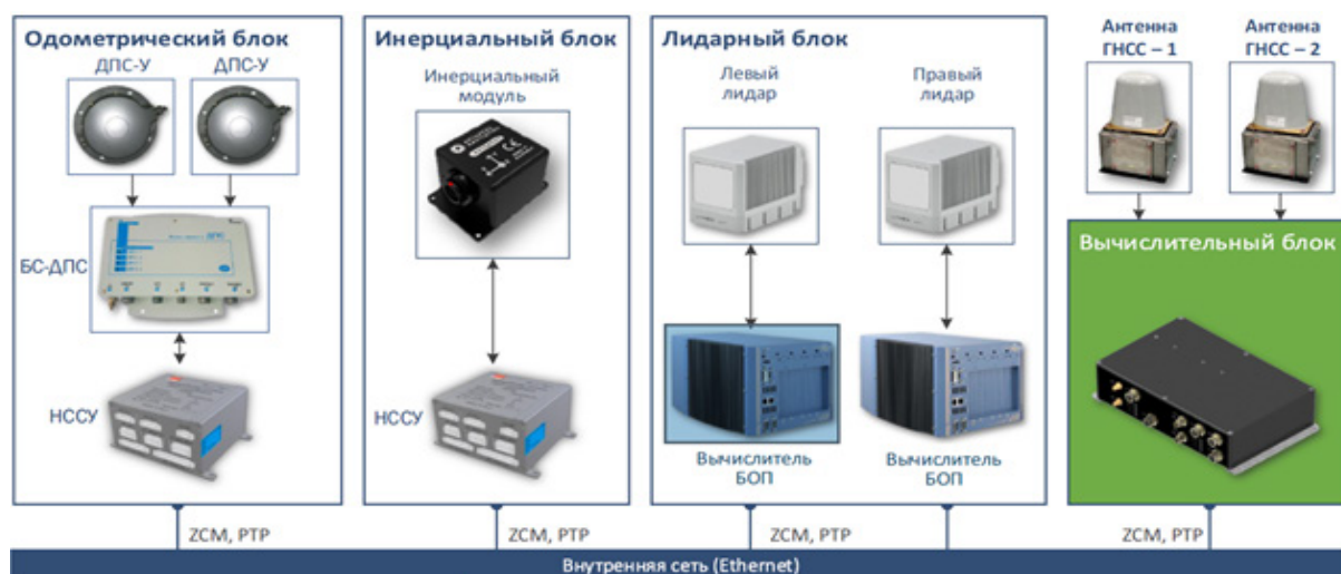
Рисунок 4 – Состав программно-аппаратного комплекса высокоточной системы позиционирования
