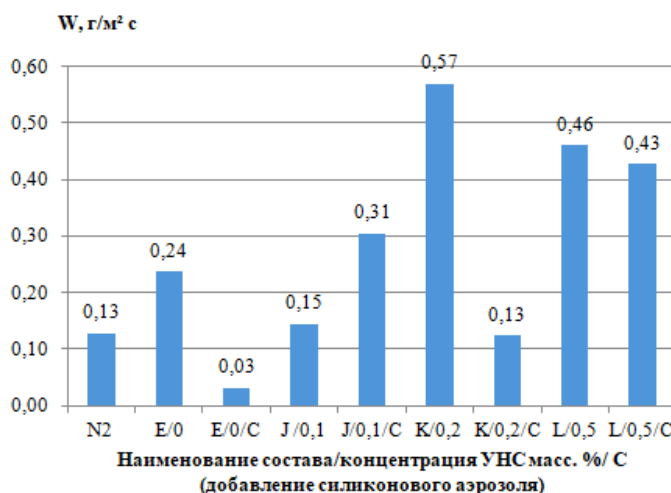
Рисунок 2 – Гистограмма зависимости интенсивности испарения жидкого азота от концентрации УНС в газонаполненных минерализованных пенах на основе 6% пенообразователя
