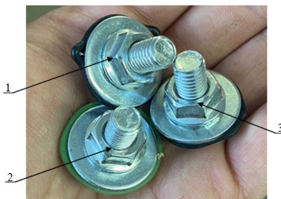
Рисунок 1 – Прокладки, закрученные между шайбами с усилием 20 Нм
