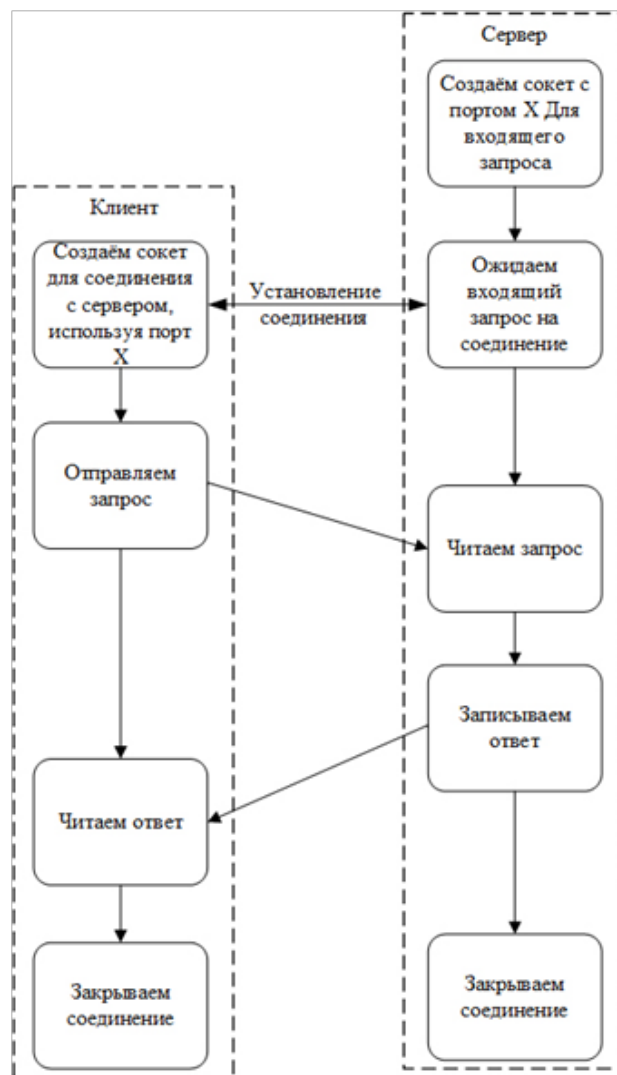
Рисунок 3 – Алгоритм передачи пакета
