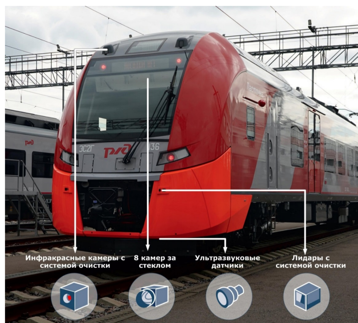
Рисунок 1 – Система технического зрения на электропоезде ЭС2Г-136
