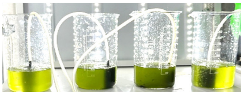
Рисунок 3 – Стеклянные фотобиореакторы с культурой микроводорослей
