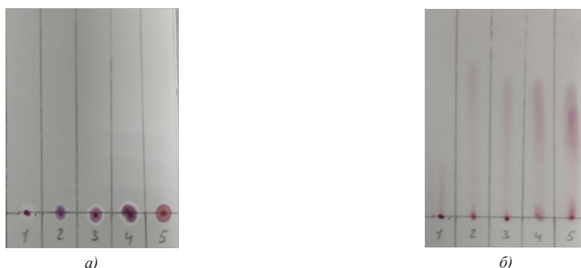
Рисунок 5 – Хроматограммы исходные (а) и после разделения (б): аммиачный раствор хлорида меди после продувки оксидом углерода (1,б) и без продувки (2,б); аммиачный раствор гидроксокарбоната меди после продувки оксидом углерода (3,б) и без продувки (4,б); ализарин-комплексон (5)
