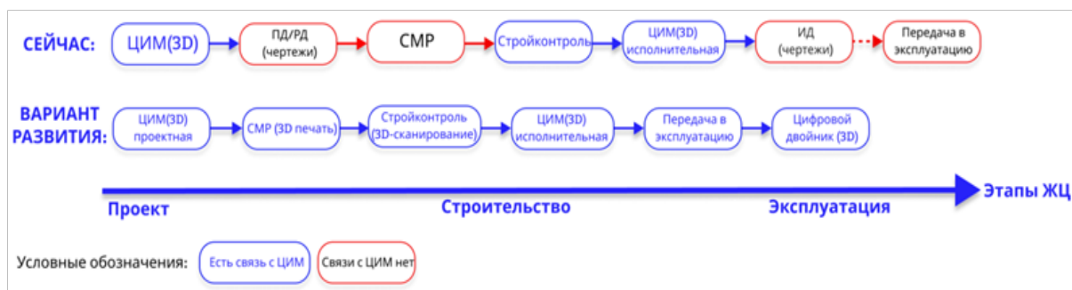
Рисунок 1 – Обобщенная схема процессов на разных этапах жизненного цикла объекта капитального строительства
