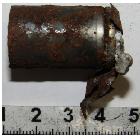
Рисунок 7 – Повреждения обнаруженные на фрагменте литий – ионного аккумулятора после пожара
