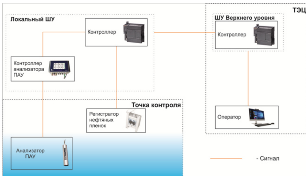
Рисунок 2 – Схема расположения оборудования на точке контроля
