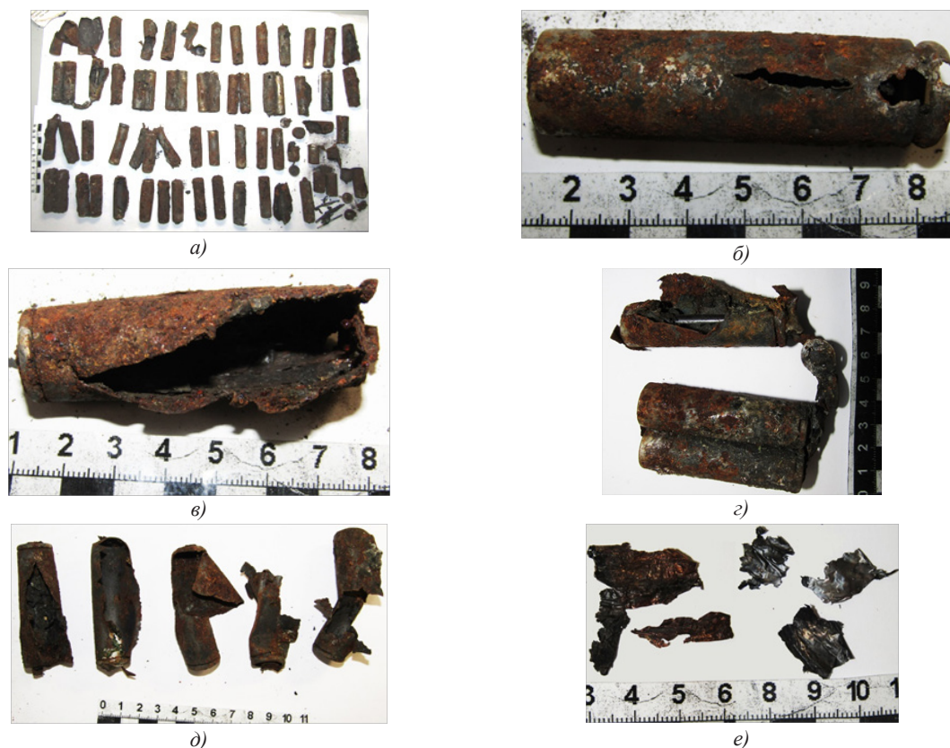
Рисунок 2 – Повреждения, обнаруженные на фрагментах литий-ионных аккумуляторных батарей
