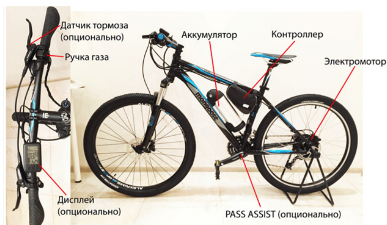
Рисунок 1 – Устройство электрического велосипеда
