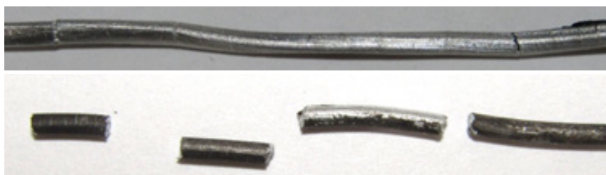
а) Фрагментация проводника на нескольких участках (незавершенная и завершенная)
