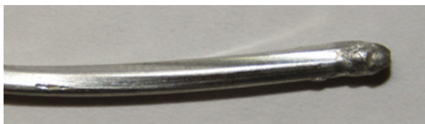
в) Локальное оплавление на конце проводника
