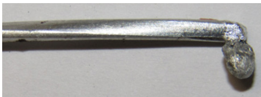
г) Локальное оплавление на конце проводника со стекающей каплей
