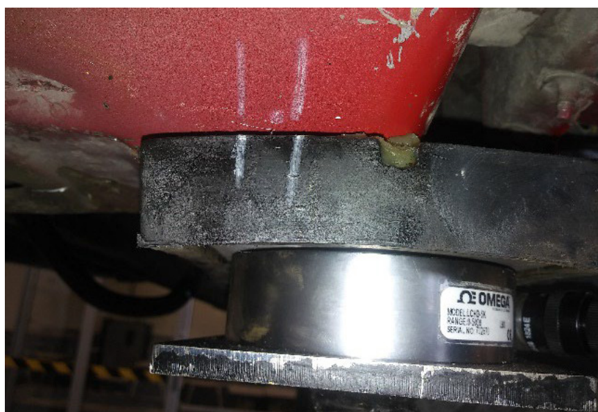
Рисунок 3 – Опора с резиновой подушкой и нанесенными метками
