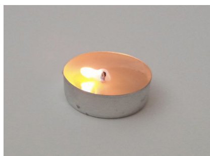
Рисунок 4 – Фотография пламени свечи, расположенной на расстоянии r=0,8 м от акустического волновода, генерирующего частоту колебаний \nu=35 Гц, меньшей на 1 Гц частоты, при которой происходит тушение пламени на данном расстоянии с использованием способа № 1
