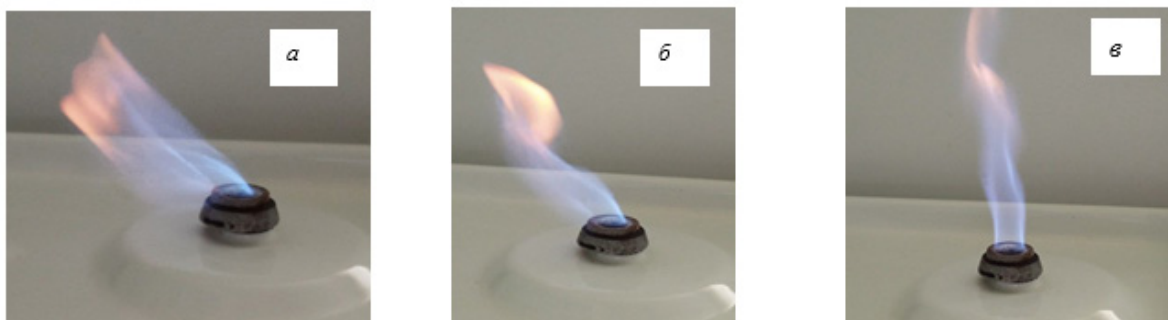
Рисунок 11 – Фотография пламени газовой конфорки без рассекателя, расположенной на расстоянии r=0,5 м от акустического волновода, генерирующего частоту колебаний \nu=12 Гц при различных углах отклонения от оси: а – \alpha=0 град; б – \alpha=5 град; в – \alpha=15 град
