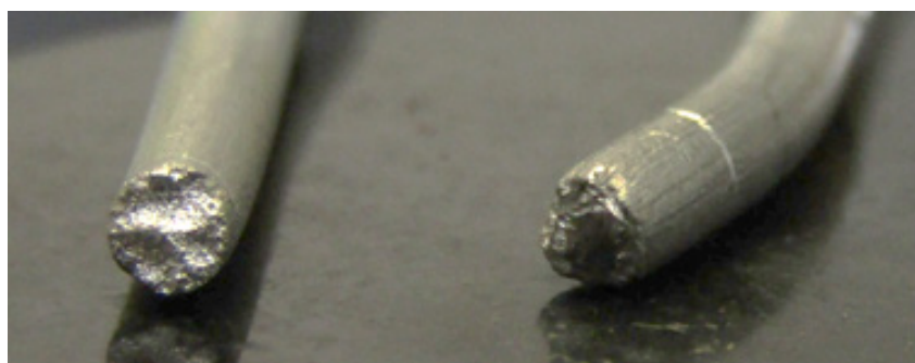
б) Разрушение на торце без образования видимых признаков плавления
