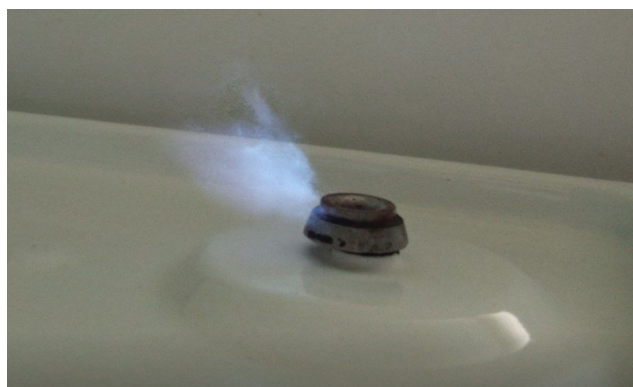
Рисунок 9 – Фотография пламени газовой конфорки без рассекателя, расположенной на расстоянии r=0,4 м от акустического волновода, генерирующего частоту колебаний \nu=11 Гц, меньшей на 1 Гц частоты, при которой происходит тушение пламени на данном расстоянии
