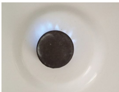
Рисунок 6 – Фотография пламени газовой конфорки с рассекателем, расположенной на расстоянии r=0,3 м от акустического волновода, генерирующего частоту колебаний \nu=33 Гц, меньшей на 1 Гц частоты, при которой происходит тушение пламени (способ № 1) на данном расстоянии
