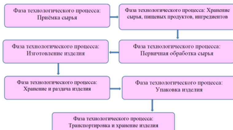
Рисунок 7 – Фазы технологического процесса производства печенья «Снуги»
