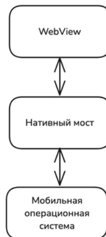
Рисунок 5 – Использование нативного моста в гибридном мобильном приложении
