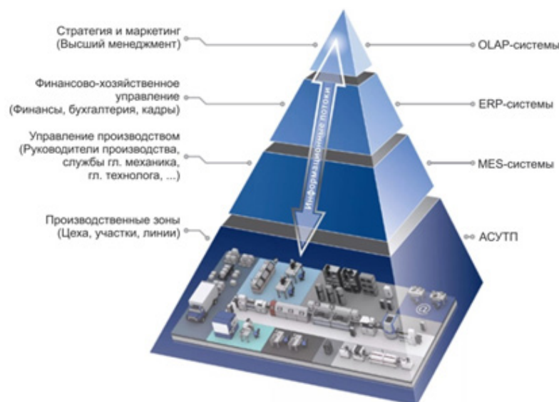
Рисунок 2 – Уровни автоматизации производственной системы
