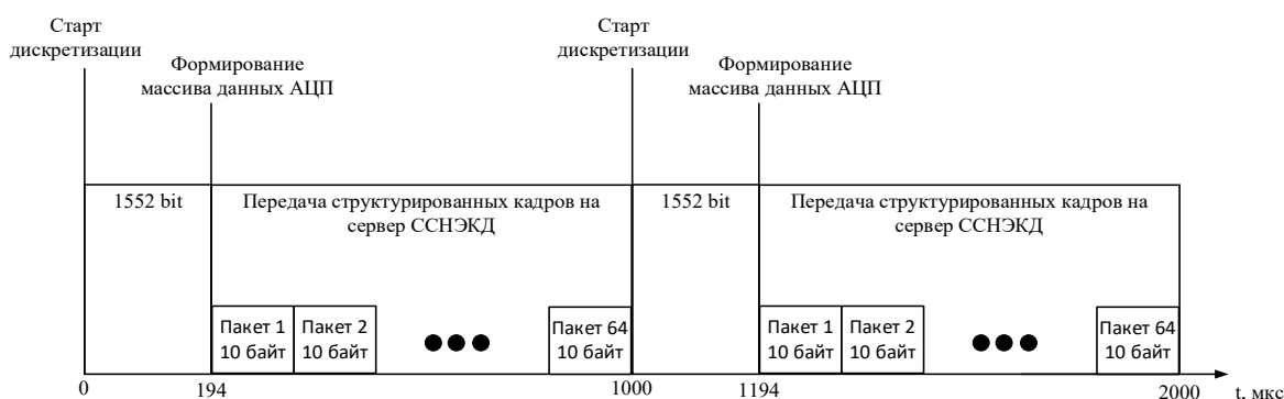
Рисунок 7 – Временная диаграмма формирования массива данных АЦП и передачи структурированных данных на сервер
