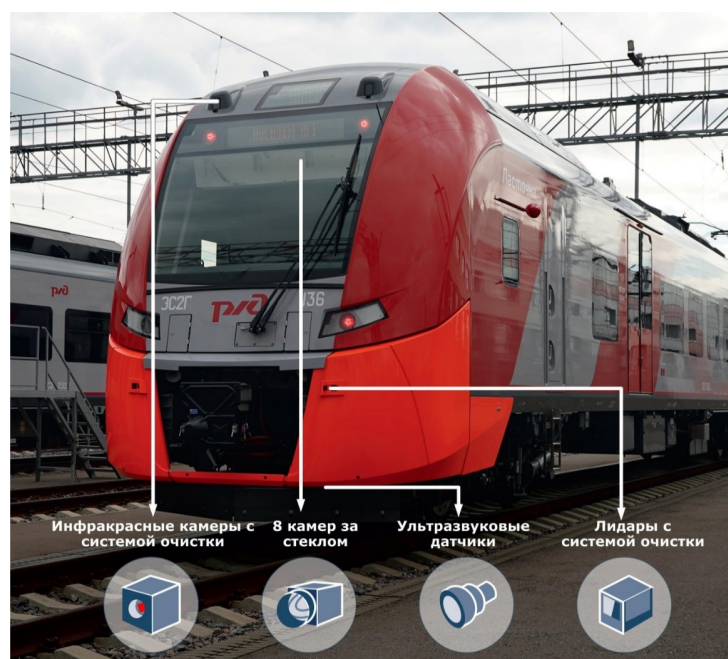
Рисунок 1 – Система технического зрения на электропоезде ЭС2Г-136
