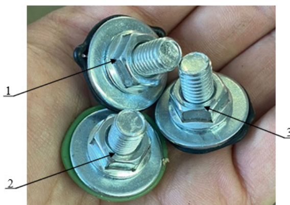
Рисунок 1 – Прокладки, закрученные между шайбами с усилием 20 Нм
