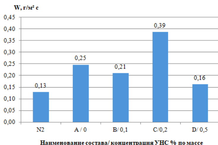
Рисунок 1 – Гистограмма зависимости интенсивности испарения жидкого азота от концентрации УНС в газонаполненных минерализованных пенах на основе 3% пенообразователя
