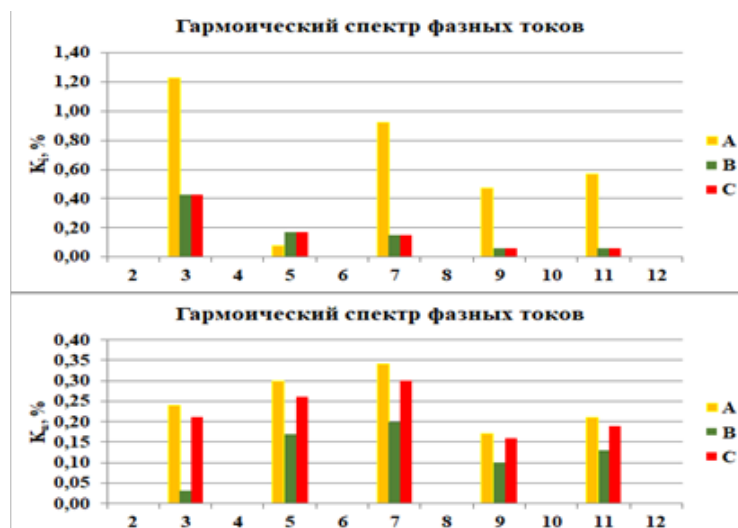
Рисунок 3 – Изменения коэффициентов гармонических искажений фазных токов и напряжений при межвитковом замыкании фазы А статора синхронной электрической машины ДСК-313-24-12
