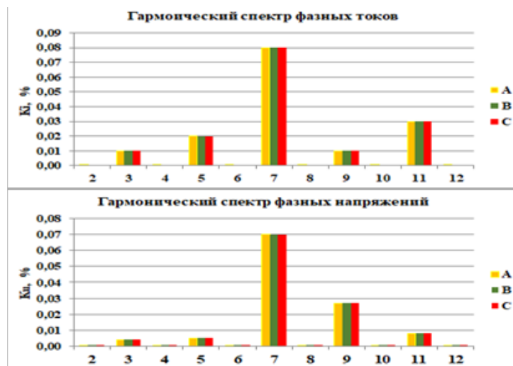
Рисунок 2 – Коэффициенты гармонических искажений фазных токов и напряжений исправной синхронной электрической машины СД-13-34-8
