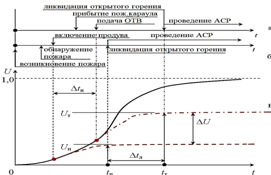
Рисунок 6 – Сравнительный эффект \Delta U тушения пожара в арктическом модуле способом продува наружным низкотемпературным воздухом [14-17] (пунктирная линия) и подачи стволов от специализированной АЦ (штрихпунктирная линия);
