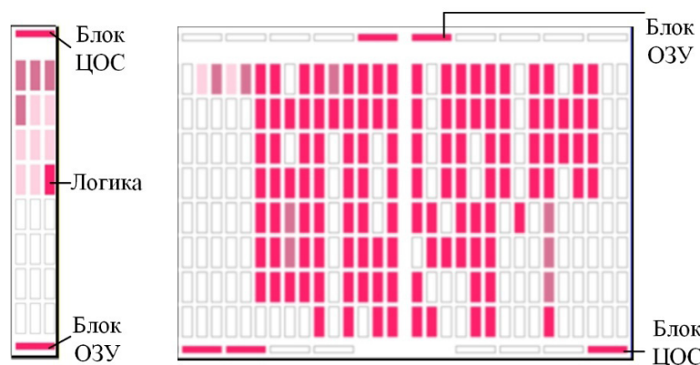
Рисунок 4 – Размещение ВБ (слева) и ОБ (справа) на ограниченной площади кристалла. Занятые ресурсы ПЛИС выделены. Программируемая логика находится между рядами блоков ЦОС и ОЗУ
