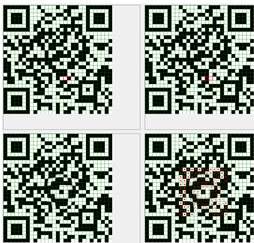
Рисунок 15 – Пример коррекции искажения с силой F = 1.57 и радиусом R = 6 пикселей (время выполнения алгоритма коррекции: 254 мкс)
